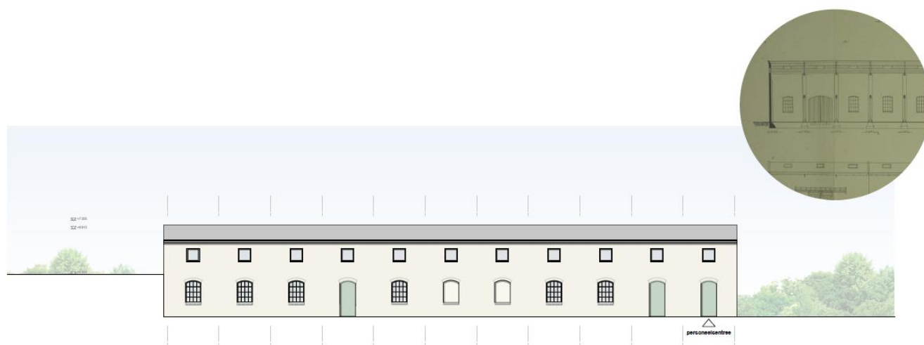
*** Westzijde terug in oude staat. De raampartijen zijn ook afgestemd op de aanwezige ruimtes.
